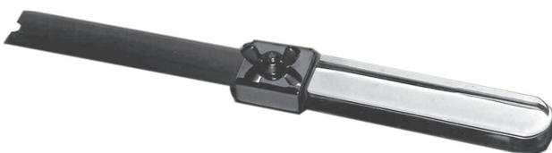
Bの上部に取り付けられたB-2の内側の窪み(深さ0.2mm)に圧着された組織を、側方の隙間からCの刃を挿入して切り取ります。
