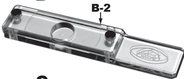
この時、Bへの圧力のかけ方により切片の厚さが調節できます。(Bが常に水平になるよう、指の位置や柄の握り方にご留意下さい。)
