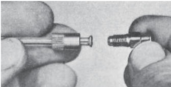
3.アダプター先端部にチューブの広げた部分をすばやく当て、キャップ部をきつく締め付けてください。
