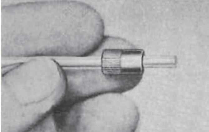
1.アダプターのキャップを外し、使用するチューブをキャップの孔に通す。
