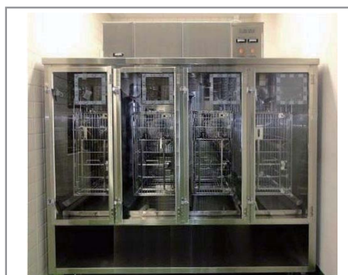
マーモセット用アイソレーター 狭体付マーモセットシングルケージを使用します。
