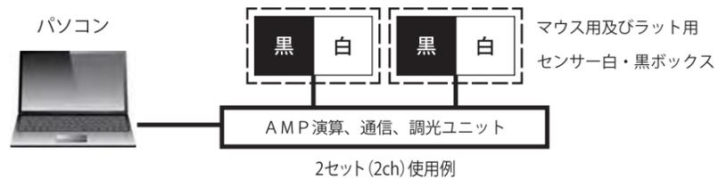
※センサーAMP、演算、通信、調光を一つのユニットに内蔵しています。測定結果をLCDで表示するため、パソコンなしでも単体で測定が可能です。
