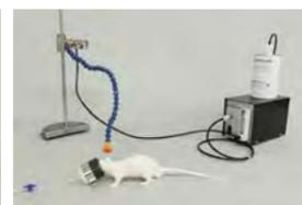
装置本体を卓上に置けない場合に、クリップ付きの吸引ノズルと装置本体を離してご使用頂けるように致しました。
