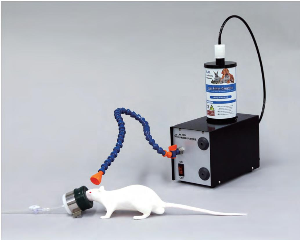
麻醉マスク等から流出する余剰麻醉ガスを吸引し、室外へ排気もしくは吸着することで作業への麻醉ガス曝露を対策します。
