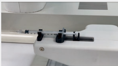
図12 5軸ステージにシリンジを設置した様子
