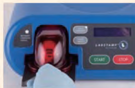
⑥保定器を本体にセットし、印字するアルファベットや数字を入力します。「START」を押すとライトが赤く点滅し、ライトが緑に変わったら印字終了です。
